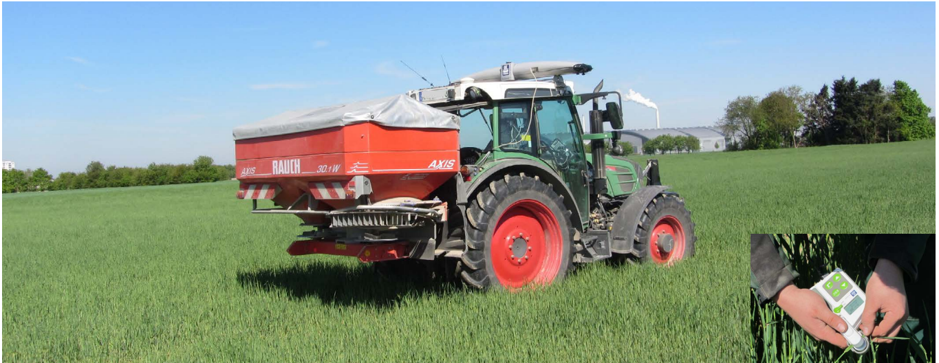
Abb. 9: Yara N-Sensor mit Düngemittelstreuer und N-Tester zum Kalibrieren des Sensors
